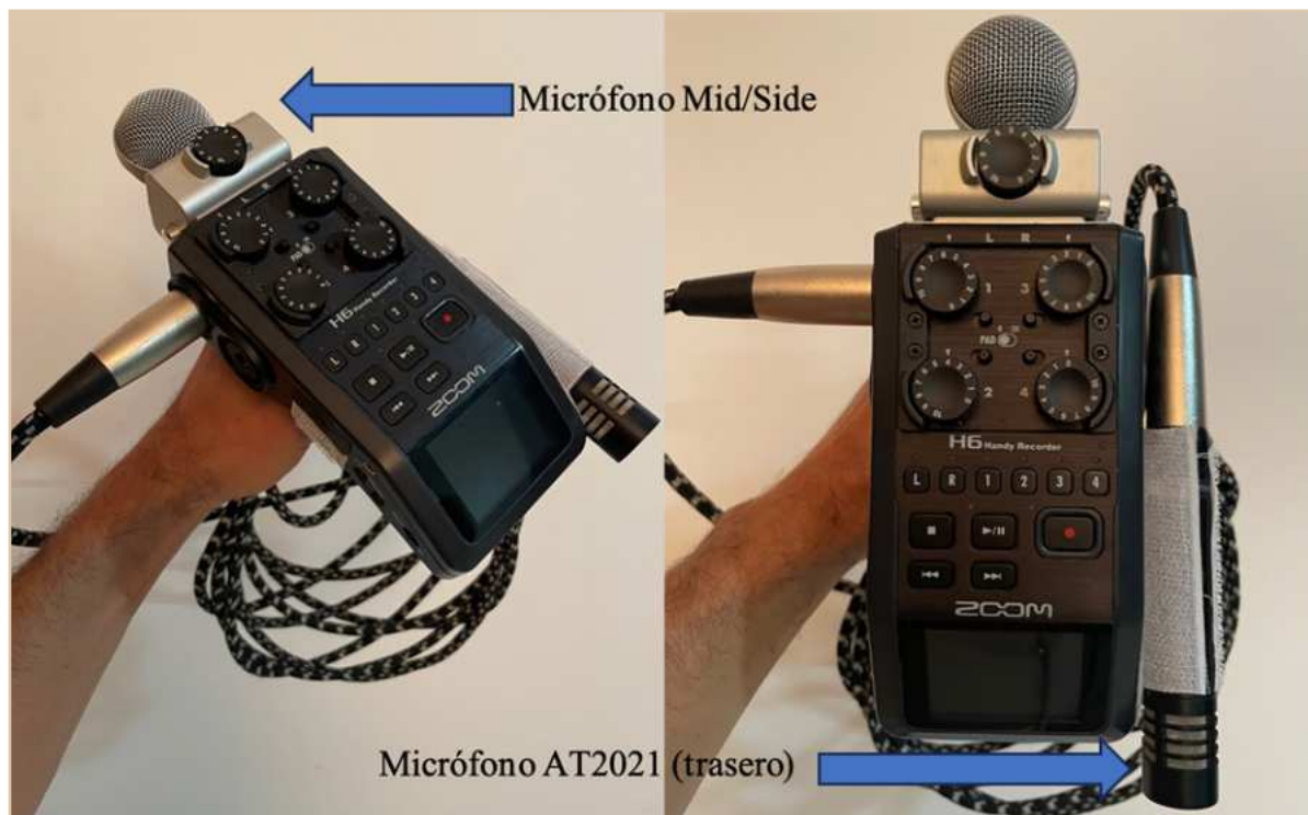
Figura 3. Grabadora Zoom H6 con cápsula M/S y micrófono Audiotehnica en disposición trasera para un Doble M/S. Fotografía de José Manuel Conejo Vargas.
